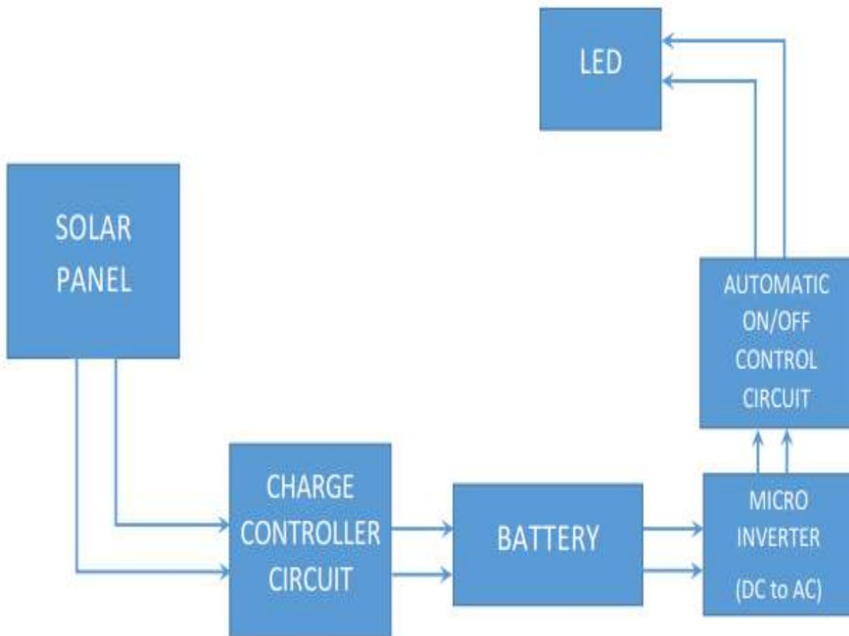
**BLOCK DIAGRAM OF AUTOMATIC SOLAR STREET LIGHT CIRCUIT**
